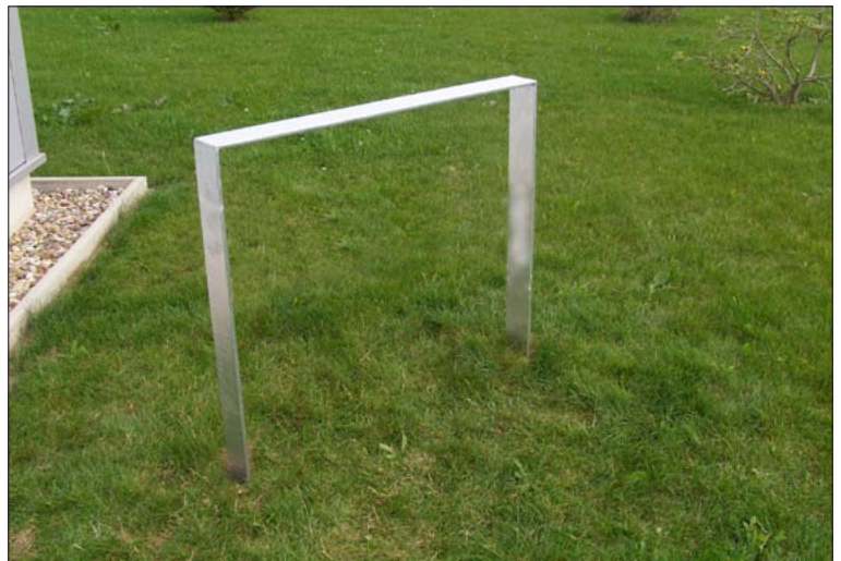
Anlehnbügel Typ „Flachstahl“ 80/12 ohne Mittelstrebe, Ausführung verzinkt mit Ecken verschweißt
